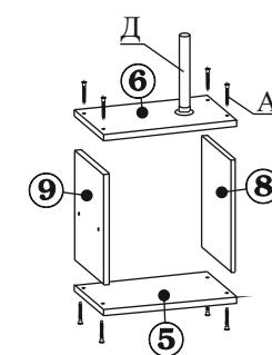
3.3. Установите полку (дет.№2). Следите чтобы труба вошла в штангодержатель. На деталь №2, установите трубу (поз.Д) и деталь №7. К детали №7 присоедините среднюю полку (дет.№4). К полученной конструкции присоедините короб, закрепив его винтовой стяжкой (поз.А) к детали №4, через деталь №9. Зафиксируйте трубы в штангодержателях.
