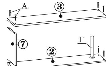
3.5. Присоедините и закрепите последовательно оставшиеся детали №2, №7 и №3, а так же трубу (поз.Г).
