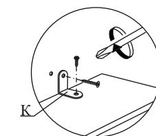
3.6. Разметте и просверлите отверстие в стене, забейте дюбель. Закрепите стеллаж к стене шурупом 4x40 сквозь деталь №10 предварительно просверлив в ней отверстие 5мм или с помощью монтажного уголка.
