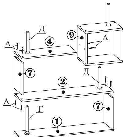
3.1. На детали №1, №2, №3, №4, №5 и №6 с помощью шурупов (поз. Е) установите штангодержатели (поз.В). Снизу на основании (дет.№1), с помощью шурупов (поз.3) установите опоры (поз.Б). Винтовой стяжкой (поз.А), закрепите деталь №7. В штангодержатель установите трубу (поз.Г), и зафиксируйте ее стопорным винтом расположенным в штангодержателе с помощью ключа (поз.Л).
