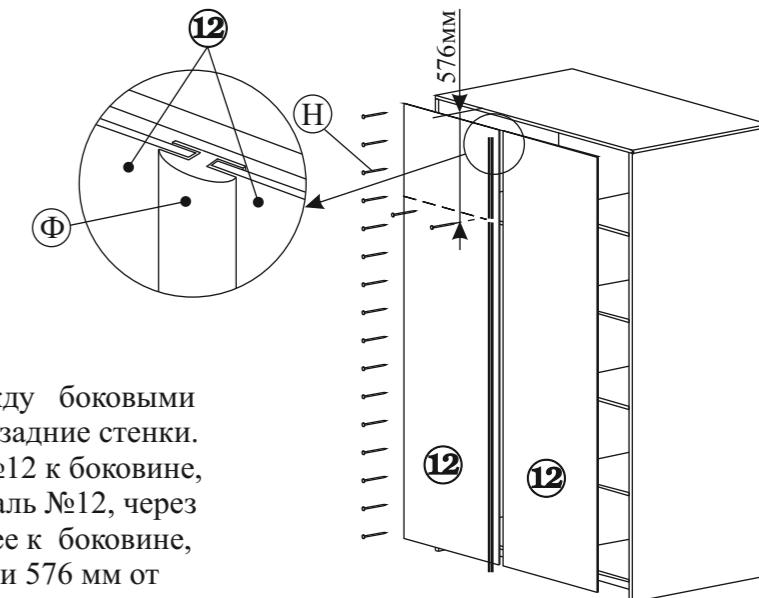
3.7. Выровняйте шкаф так, чтобы между боковыми стенками и дном был прямой угол. Установите задние стенки. Для этого: Закрепите гвоздями (поз.Н) Деталь №12 к боковине, дну и крышке. Затем присоедините вторую деталь №12, через стыковочный профиль (поз.X), и закрепите ее к боковине, дну и крышке. И к полке (дет.№5) на расстоянии 576 мм от верхней плоскости крышки (дет.№3).
