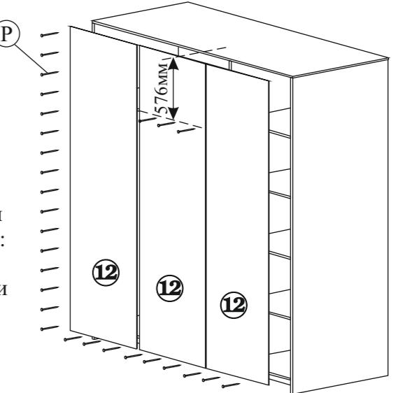
3.7. Выровняйте шкаф так, чтобы между боковыми стенками и дном был прямой угол. Установите задние стенки. Для этого: Закрепите гвоздями (поз.Р), деталь №12, к перегородкам, дну, крышке и полке (дет.№5) на расстоянии 576мм от верхней плоскости крышки(дет.№3). После чего закрепите остальные детали.
