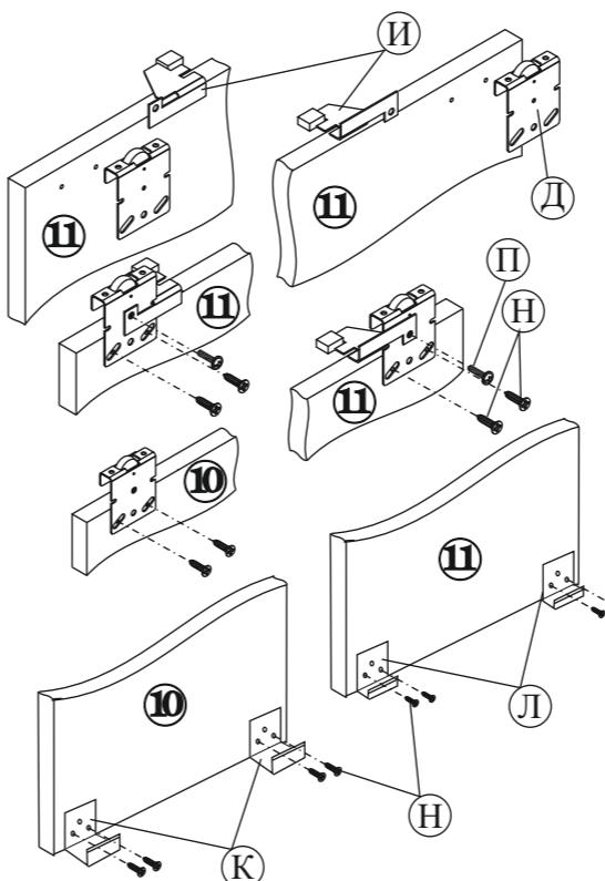
3.8. На боковые двери (дет.№11) установите ходовые ролики (поз.Д) и стопоры (поз.И). Причем стопор ставится на ролик находящийся ближе к боковине шкафа, а амортизатор стопора направлен к центру шкафа. Для крепления стопора к ролику используйте винт (поз.П). На центральную дверь (дет.№10) устанавливаются ролики без стопоров.
