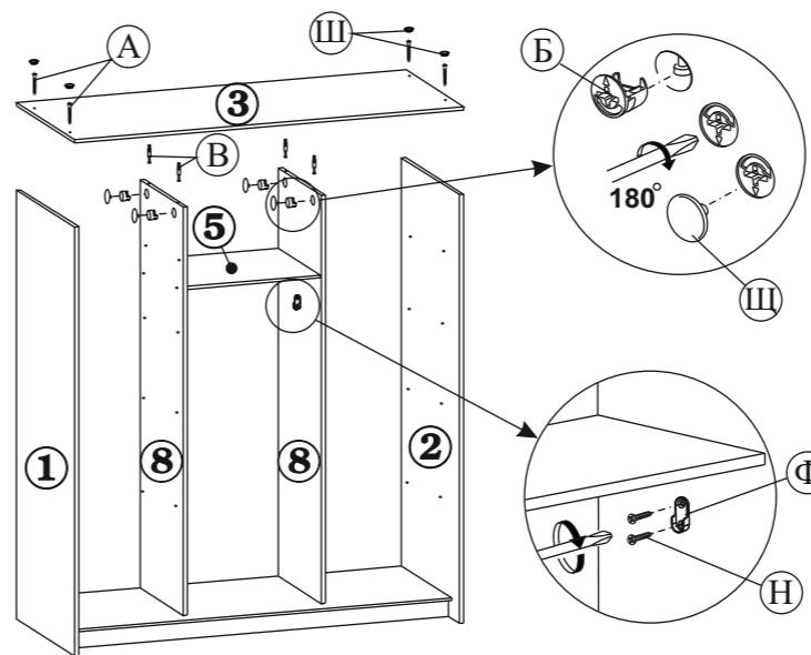
3.6. В крышку (дет.№3) вкрутите четыре штока эксцентрика (поз.В). Затем установите крышку на каркас шкафа, закрепив ее винтовыми стяжками с боками (дет. №1 и №2) и установив эксцентрики (поз.Б) в перегородки (дет.№8) поверните их на 180 градусов по часовой стрелке. На деталях №8, под полкой (дет.№5), шурупами закрепите штангодержатели (поз.Ф). Установите штангу (поз.X).
