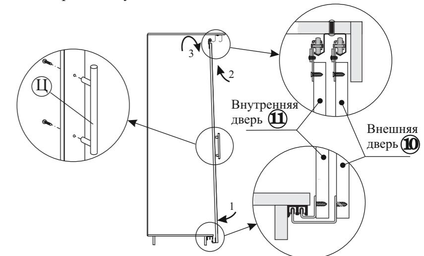
3.10. Установите планку (дет.№9), закрепив ее винтовой стяжкой (поз.А). Установите ручки (поз.Ц).
