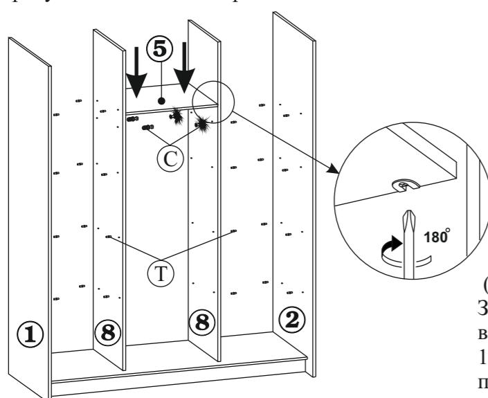
3.5. В детали №8, вкрутите дюбели ввинчиваемые (поз. С). Установите на них полку (дет.№5). Зафиксируйте ее повернув винты вмонтированных в полку эксцентриков по часовой стрелке на 180 градусов. В детали №1, №2 и №8, установите полкодержатели (поз.Т).
