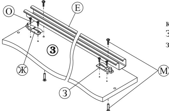
3.1. При помощи шурупов (поз.О) закрепите на крышке (дет.№3) правый и левый фиксаторы (поз.Ж и 3). Затем при помощи межсекционной стяжки (поз.М), закрепите верхний ходовой профиль (поз Е).
