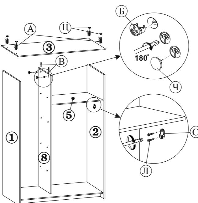
3.6. В крышку (дет.№3) вкрутите два штока эксцентрика (поз.В). Затем установите крышку на каркас шкафа, закрепив ее винтовыми стяжками с боками (дет. №1 и №2) и установив эксцентрики (поз.Б) в перегородку (дет.№8) поверните их на 180 градусов по часовой стрелке. На деталях №2 и №8, под полкой (дет.№8), шурупами закрепите штангодержатели (поз.С). Установите штангу (поз.T).
