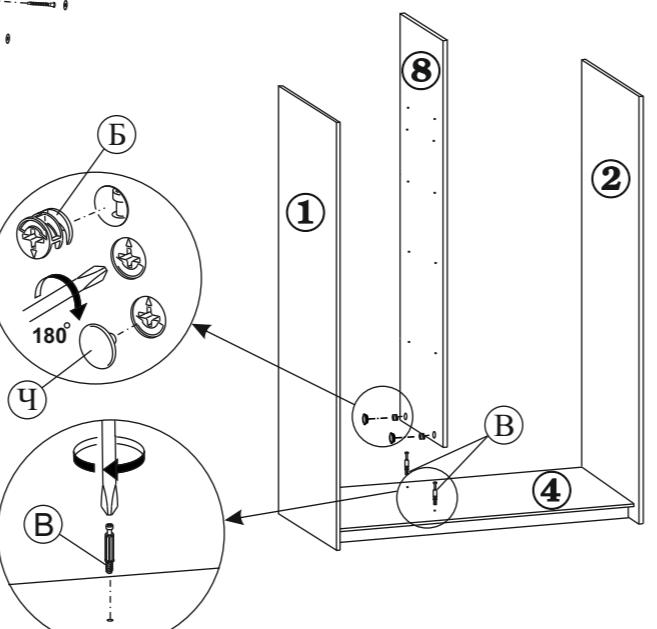
3.5. В детали № 2 и №8, вкрутите дюбели ввинчиваемые (поз. О). Установите на них полку (дет.№5). Зафиксируйте ее повернув винты вмонтированных в полку эксцентриков по часовой стрелке на 180 градусов. В детали №1 и №8, установите полкодержатели (поз.П).
