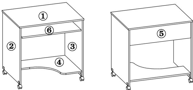
3.1. Закрепите на боковые торцы выкатной полки дет.№6 ответные планки направляющих (поз.Г-2) с помощью шурупов 3,5x16 (поз.Д), роликами назад.
