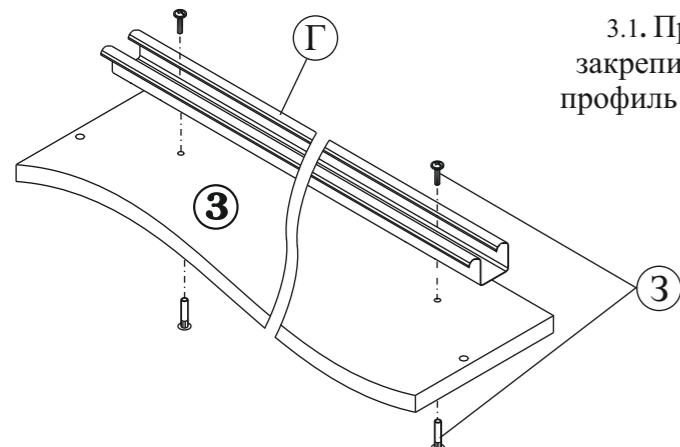
3.1. При помощи межсекционной стяжки (поз.3), закрепите на крышке, (дет.№3) верхний ходовой профиль (поз Г).
