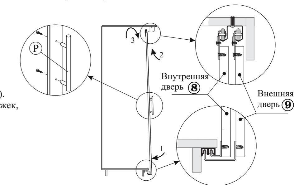
3.10. Установите планку (дет.№7), закрепив ее винтовой стяжкой (поз.А).
