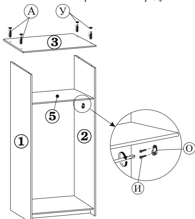
3.6. Установите крышку (дет.№3) на каркас шкафа, закрепив ее винтовыми стяжками (поз.А), с боками (дет. №1 и №2). На деталях №1 и №2, под полкой (дет.№5), шурупами закрепите штангодержатели (поз.О). Установите штангу (поз.П).
